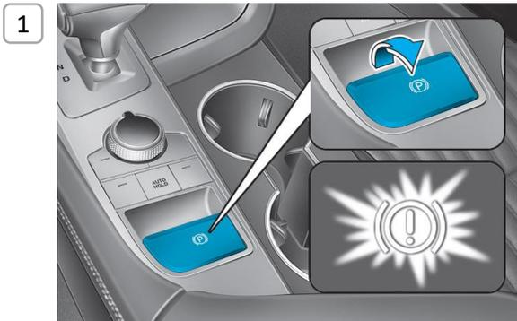
1. Unterlegkeile unterlegen und Schalter herausziehen, um Feststellbremse zu betätigen.
