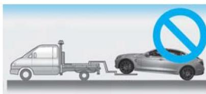
Hinweis: Fahrzeug nicht mit Abschlepphaken ziehen. Abschleppwagen mit Hebevorrichtung oder Ladefläche verwenden. Fahrzeug darf nicht auf Hinterrädern abgeschleppt werden, da es dabei beschädigt werden könnte.
