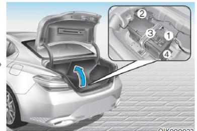
1. Heckklappenöffner (auf Armaturentafel) gedrückt halten, um elektrische Heckklappe zu öffnen.
