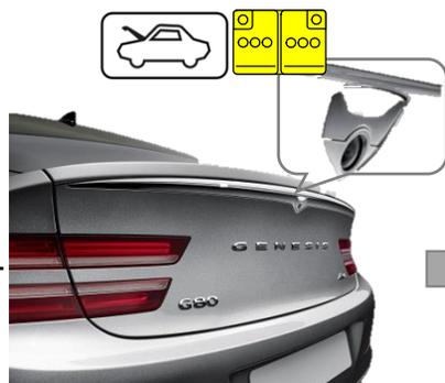
1. Pour ouvrir le coffre électrique, maintenez enfoncé le bouton d'ouverture du coffre situé sur le tableau de bord.
