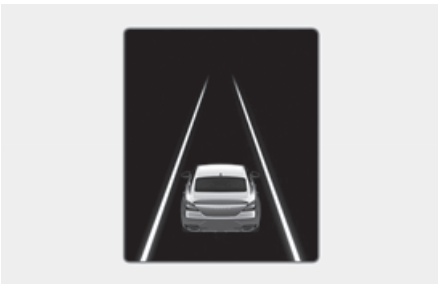
Break - Voie non détectée
