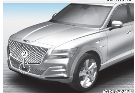
[1] : Caméra frontale, [2] : Radar avant
