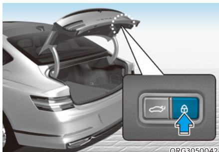
4. Bouton de verrouillage de coffre électrique
