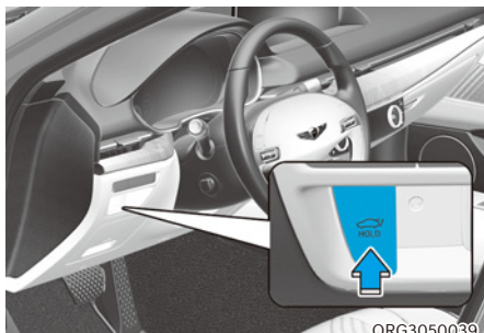
1. Bouton de commande principal de coffre électrique
