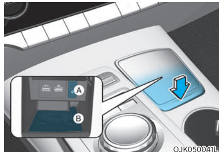
[A]: Kontrollleuchte, [B]: Ladekissen
