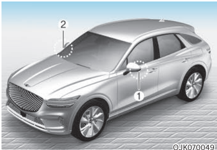
[1], [2]: Weitwinkelkamera (Kamera am unteren Rand des Spiegels)
