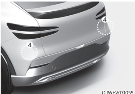
[1]: Frontkamera, [2]: Frontradar, [3]: Eckradar vorn (ausstattungsabhängig), [4]: Eckradar hinten
