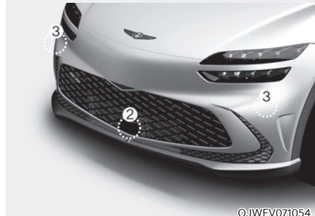
[1]: Frontkamera, [2]: Frontradar [3]: Eckradar vorn (ausstattungsabhängig),
