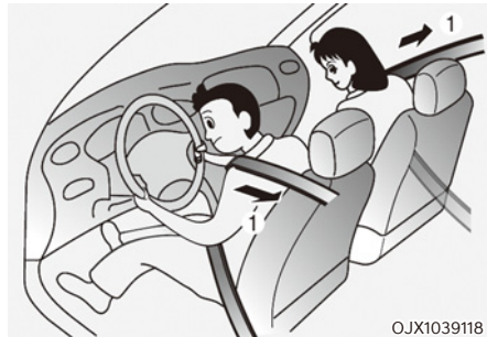
[1]: Sicherheitsgurt mit Gurtstraffer Vordersitz und äußerer Sitz zweite Sitzreihe (ausstattungsabhängig)
